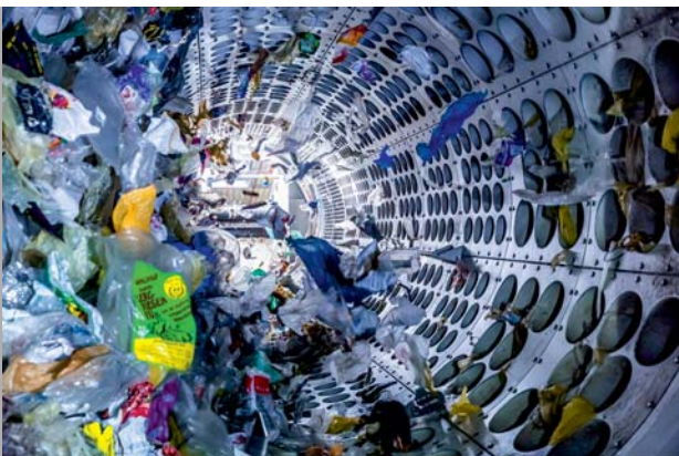
Die Siebtrommel trennt kleine von großen Verpackungen
